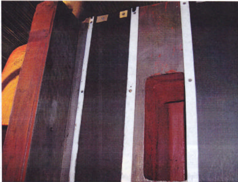
Рис. 5 – Поверхність відреставрованих напрямлюючих на расточній бабці після полімеризації матеріала „Моглайс FL/P”
