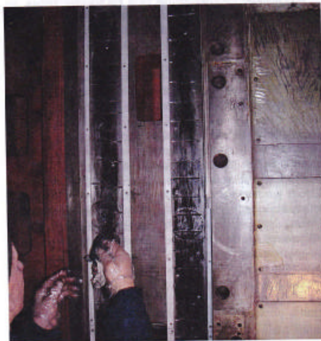
Рис. 2 - Процесс предварительного втирания первого адгезионного слоя материала „Моглайс FL/P” в поверхность направляющих
