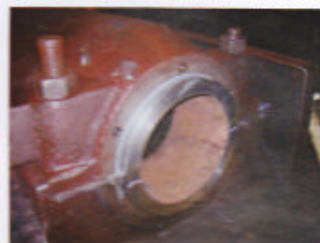
Рис. 5. Восстановление изношенной поверхности в крышке с помощью шаблона.
