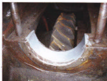
Рис. 6. Восстановленная опорная поверхность в корпусе.
