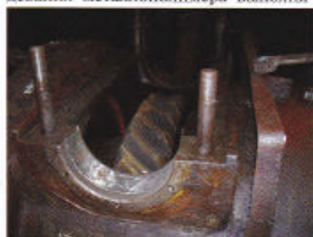
Рис. 2. Изношенная опорная поверхность в корпусе редуктора.
