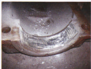
Рис. 3. Изношенная опорная поверхность в крышке редуктора.
